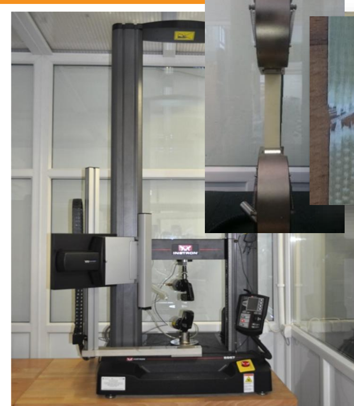
Maszyna wytrzymałościowa do badania wytrzymałości na rozciąganie, zginanie, ściskanie i ścinanie
