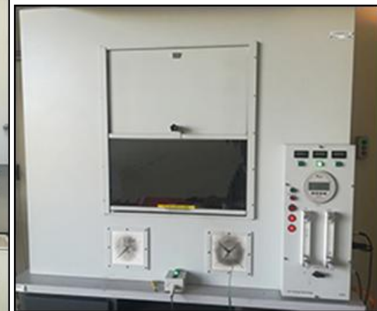
Komora UL94 do określania klas palności
