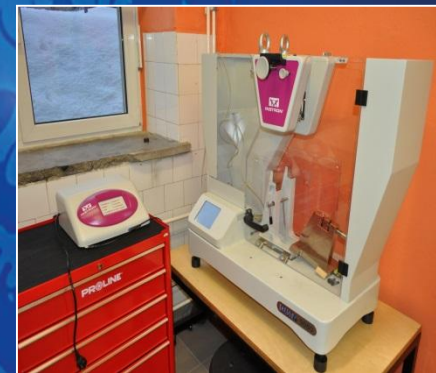
Młotek do badań udarności Cherpy'ego i Izolda z pomiarem siły i energii udu
