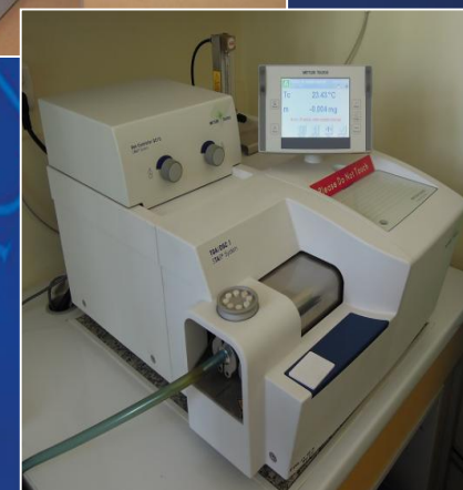
Aparat TGA sprzężony ze spektrometrem mas i spektrometrem FTIR
