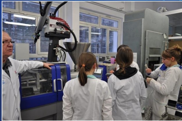
Wtryskarka Batenfeld wyposażona w robot Wittmann, wtrysk z gazem oraz termostat szybkiego chłodzenia
