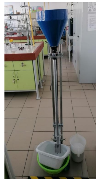
Oznaczanie odporności powłok na ścieranie przyrządem Gardnera
