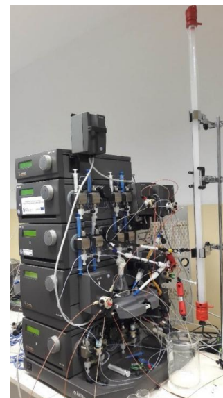
Układ SMB do chromatografii ciągłej białek. Stanowisko złożone z 6 zestawów chromatograficznych AKTA purifier, (GE Healthcare Life Sciences, Szwecja), pracujące na dowolnym układzie szeregowo-równoległym kolumn.
