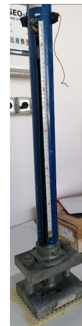
Pomiar odporności na uderzenie wg Du Pont'a
