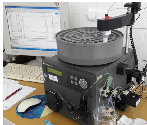
Chromatograf ciekłowy AKTA prime-plus z detektorami UV oraz konduktometrycznym (GE Healthcare Life Sciences, Szwecja)
