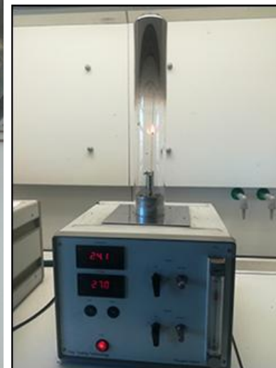
Aparat do oznaczania indeksu tlenowego LOI
