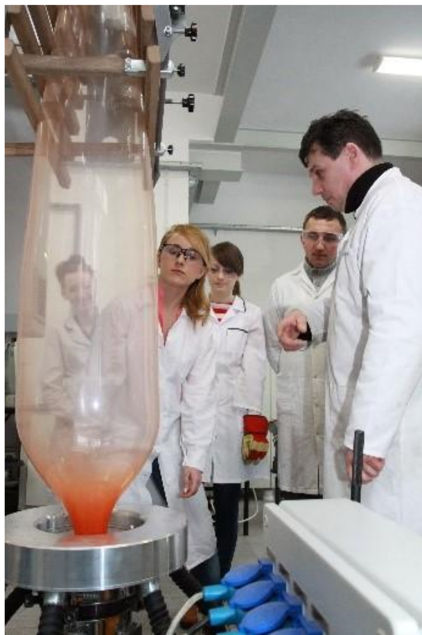
Linia do otrzymywania folii metodą rozdmuchu
