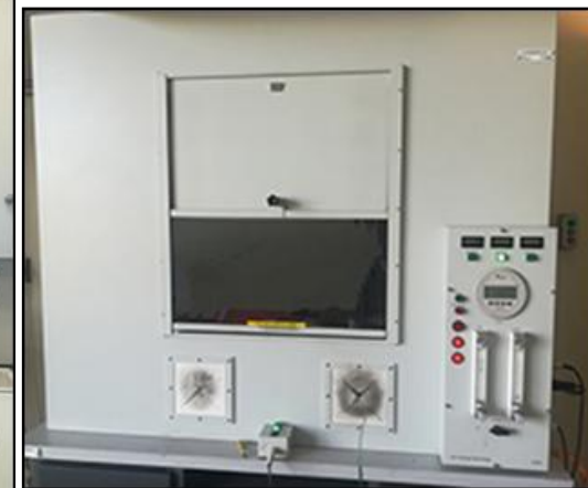
Komora UL94 do określania klas palności
