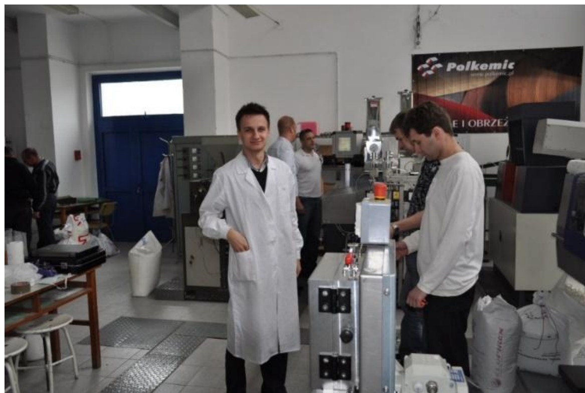
Linia do wytłaczania kompozytów termoplastycznych
