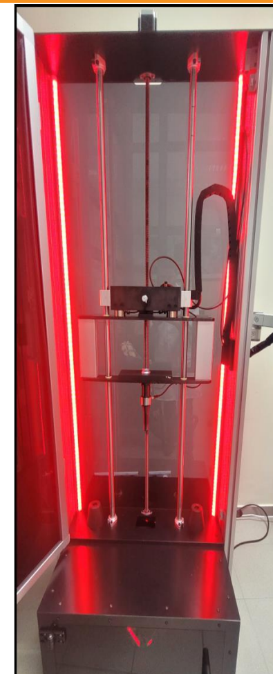
Udarność metodą spadającego grota
