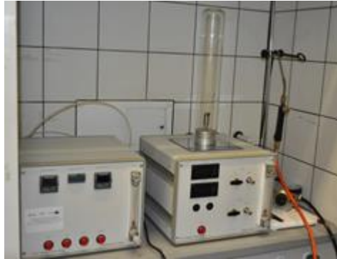
Aparat do oznaczania indeksu tlenowego LOI
