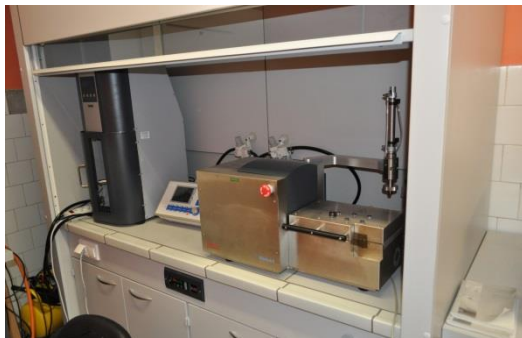
Minilab-mikrowytlaczarka z miniwtryskarką firmy Haake
