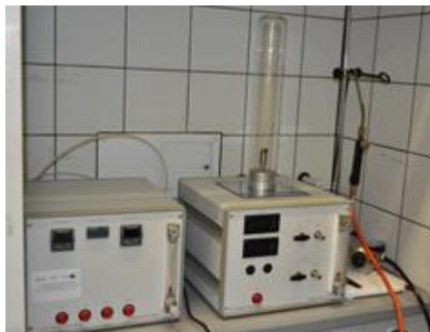
Aparat do oznaczania indeksu tlenowego LOI
