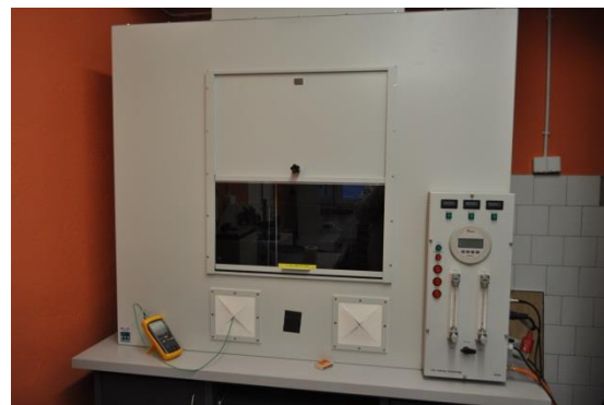
Komora do badań palności wg UL-94
