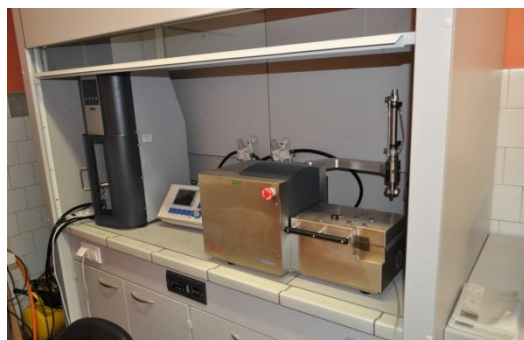
Minilab-mikrowytlaczarka z miniwtryskarką firmy Haake
