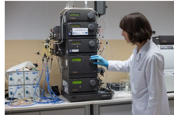
Rozdzielanie białek w wielokolumnowym układzie chromatograficznym. Chromatograf Äkta purifier firmy GE Healthcare
