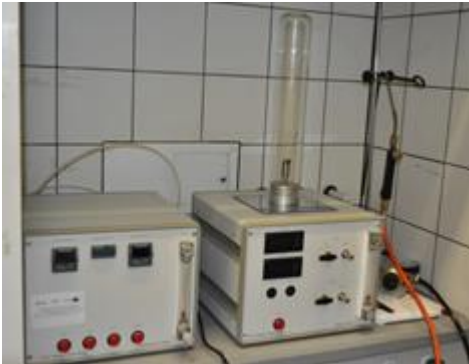
Aparat do oznaczania indeksu tlenowego LOI
