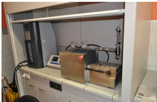
Minilab-mikrowytlaczarka z miniwtryskarką firmy Haake
