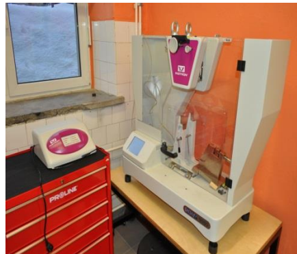
Młotek do badań udarności Cherypy'ego i Izoda z pomiarem siły i energii udaru
