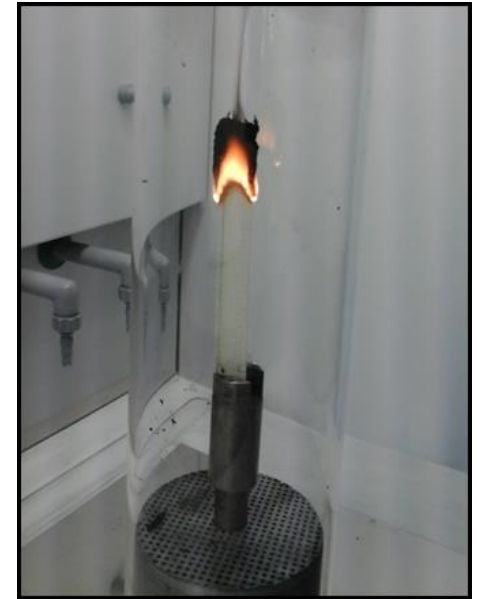
Aparat do oznaczania wskaźnika tlenowego LOI FFT
