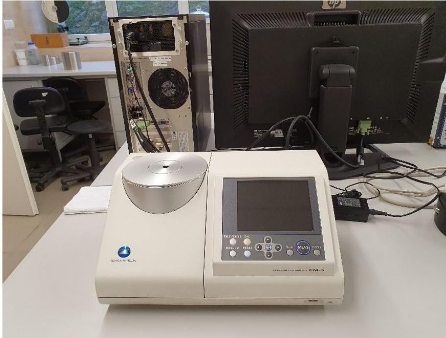
Spektrometr do oznaczania barwy wyrobów polimerowych, firmy Konica Minolta
