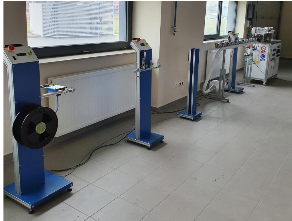
Linia do otrzymywania kompozytów w technologii Rapid Prototyping
