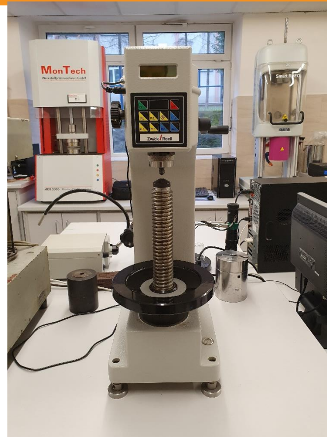
Twardościomierze do określania twardości różnego rodzaju tworzyw i kompozytów polimerowych
