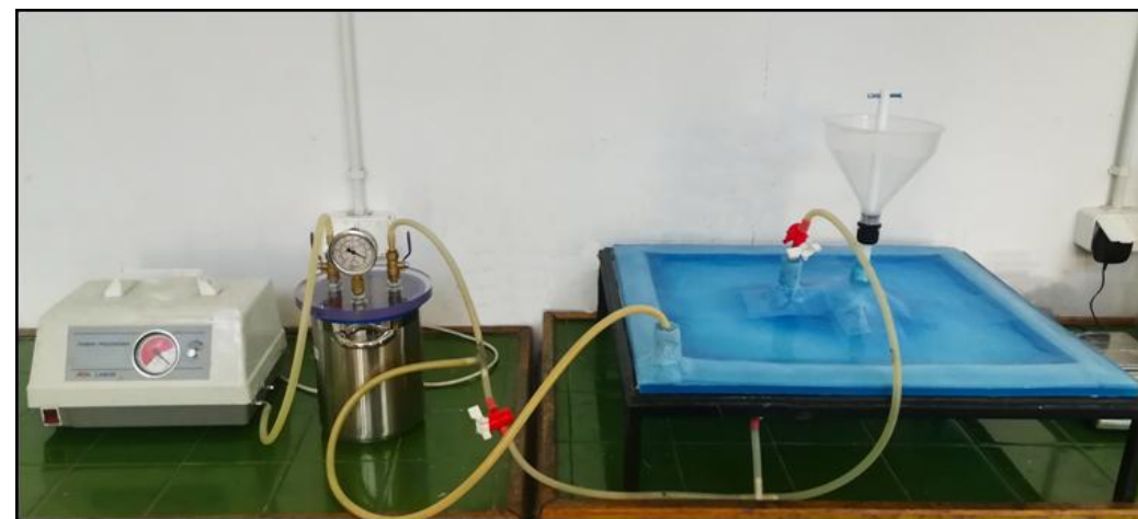
Linia do otrzymywania kompozytów metodą infuzji z wykorzystaniem membrany silikonowej
