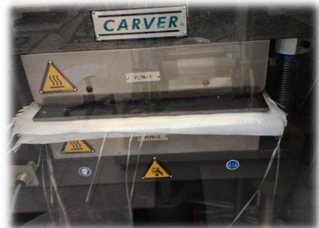
Linia do otrzymywania kompozytów metodą RTM
