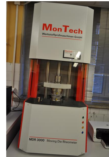
Wulkametr MonTecha do oznaczania procesu wulkanizacji mieszanek gumowych
