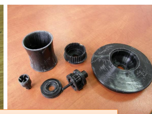
Komora próżniowa i widok elementów przekładni robota kuchennego odlanych w formie silikonowej
