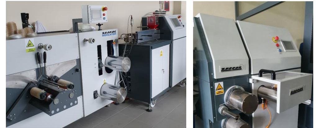
Linia do otrzymywania włókien z materiałów polimerowych
