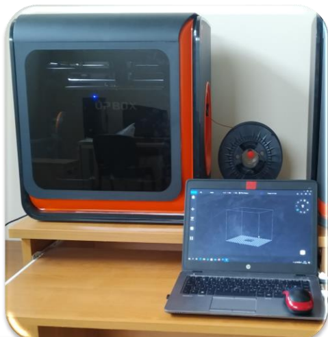
Technologia RP tzw. wytłaczania warstw stopionego polimeru
