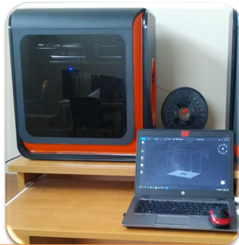
Technologia RP tzw. wytłaczania warstw stopionego polimeru
