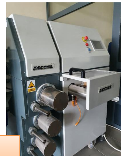
Linia do otrzymywania włókien z materiałów polimerowych
