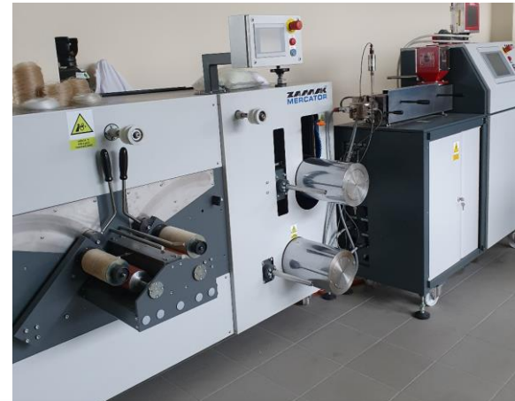
Linia do otrzymywania włókien z materiałów polimerowych
