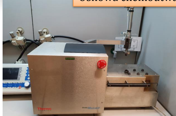
Miniwytłaczarka dwuślakowa Haake MiniLab II
