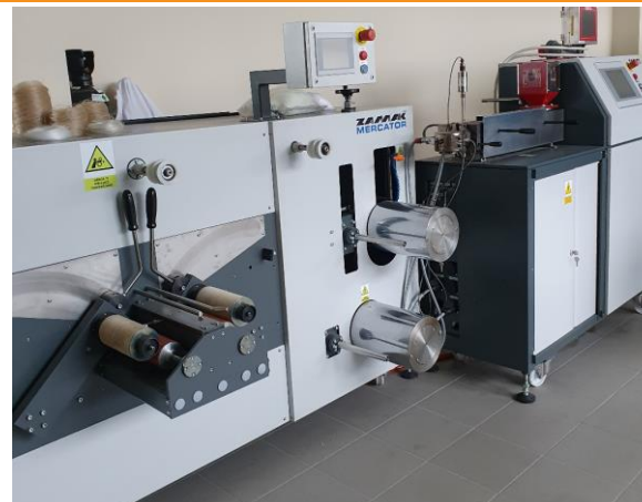
Linia do otrzymywania włókien z materiałów polimerowych
