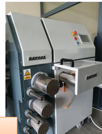
Linia do otrzymywania włókien z materiałów polimerowych
