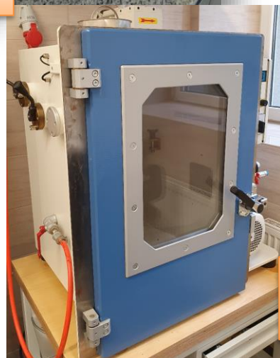
Komora próżniowa i widok elementów przekładni robota kuchennego odlanych w formie silikonowej
