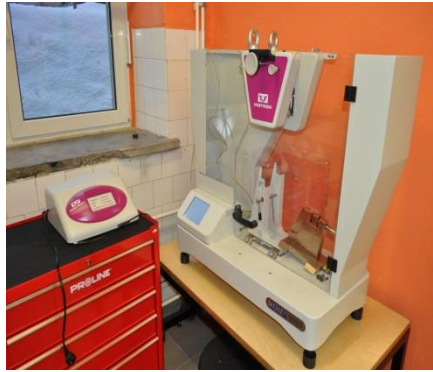
Młotek do badań udarności Cherypy'ego i Izoda z pomiarem siły i energii uderu
