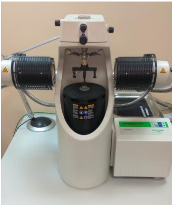
Aparat do dynamicznej analizy termicznej (DMTA)
