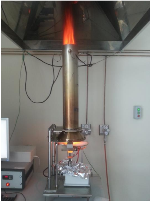
Mikrokalorymetr stożkowy FFT
