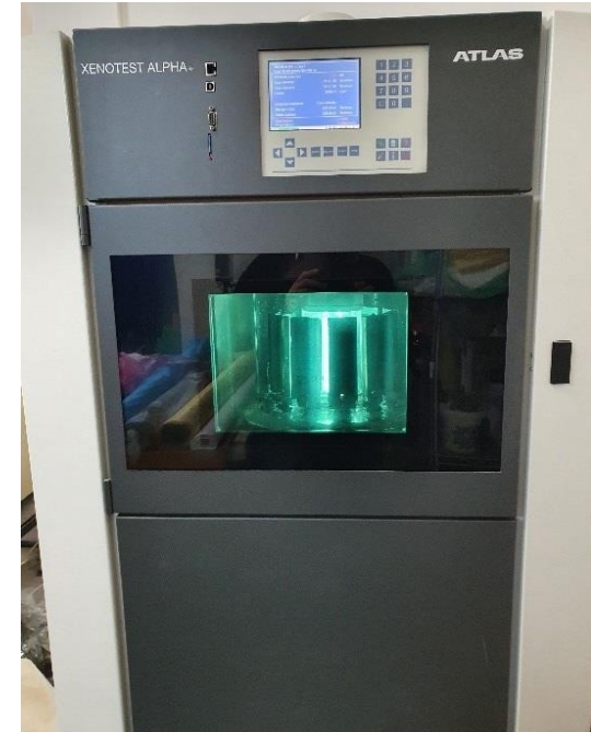
Komora do badań starzeniowych Xenotest firmy ATLAS
