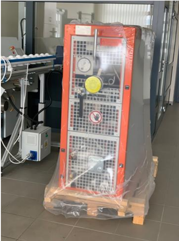
Termostat do wtryskarki Krauss Maffei ClassiX CX -50 180
