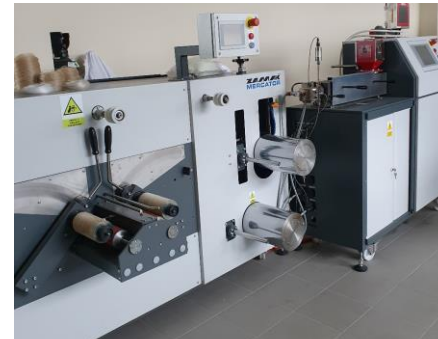
Linia do otrzymywania włókien z materiałów polimerowych
