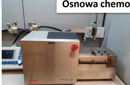
Miniwytłaczarka dwuślimakowa Haake MiniLab II
