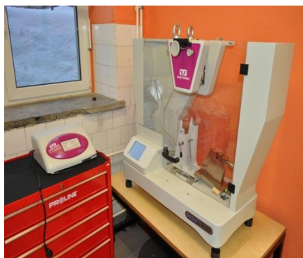
Młotek do badań udarności Cherpy'ego i Izoda z pomiarem siły i energii uderu
