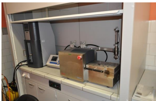
Minilab-mikrowytlaczarka z miniwtryskarką firmy Haake
