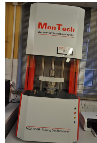
Wulkametr MonTecha do oznaczania procesu wulkanizacji mieszanek gumowych
