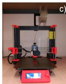
Rys.3. Widok drukarek: a) SLS wraz z komputerem sterującym, b) 3SP, c) FDM/MEM, d) JS
