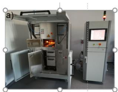
Rys.3. Widok drukarek: a) SLS wraz z komputerem sterującym, b) 3SP, c) FDM/MEM, d) JS
