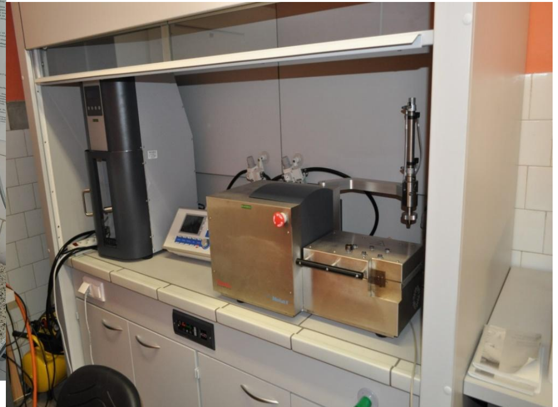
Przygotowanie nanokompozytów polimerowych z wykorzystaniem miniwtryskarki i miniwytlaczarki
