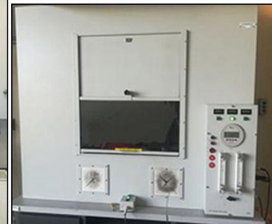
Komora UL94 do określania klas palności
