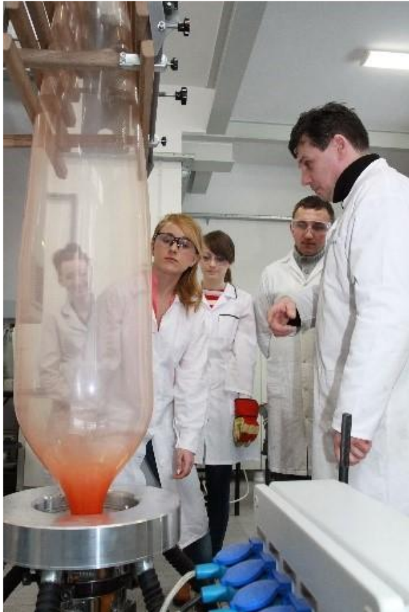
Linia do otrzymywania folii metodą rozdmuchu
