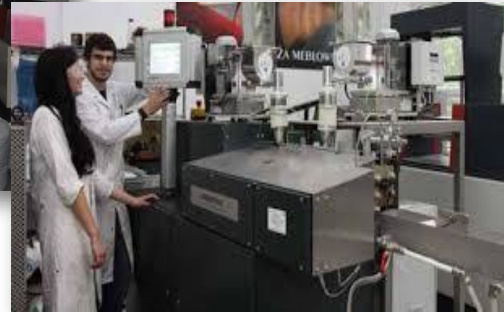
Linia do wytłaczania mieszanek polimerów termoplastycznych
