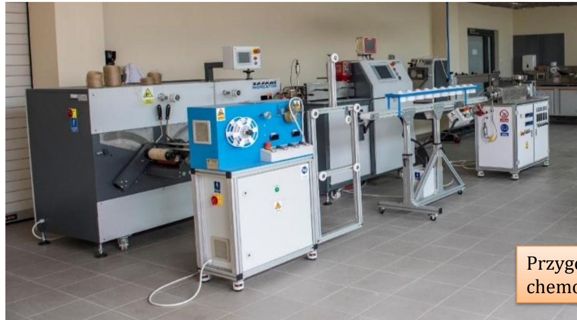
Linia do otrzymywania włókien polimerowych oraz kompozytów polimerowych stosowanych w technologiach szybkiego prototypowania w postaci filamentu
