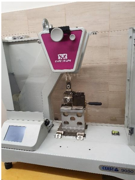
Młot do badań udarności Charpy'ego, Izoda z możliwością rejestracji momentu złamania próbki
