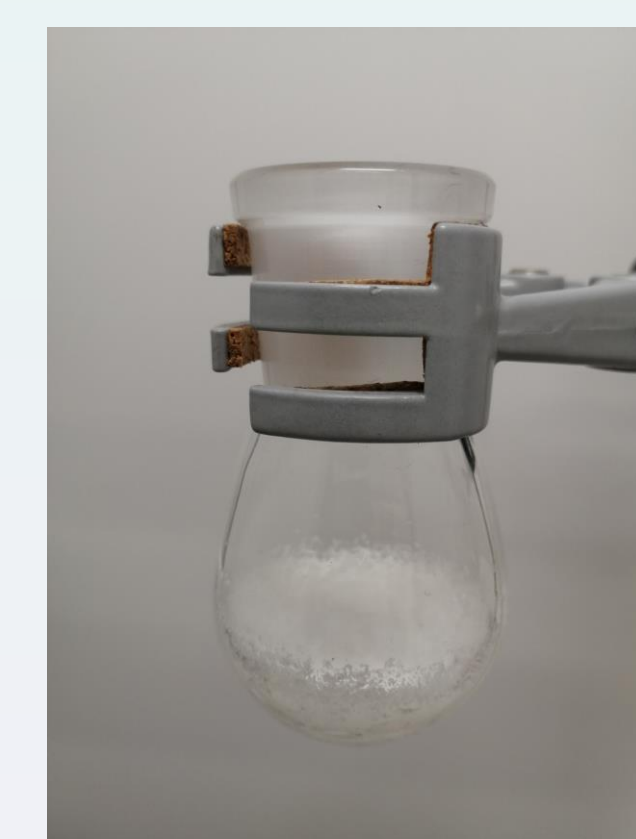
WEFG wydzielany za pomocą chromatografii kolumnowej z surowej mieszaniny poreakcyjnej
