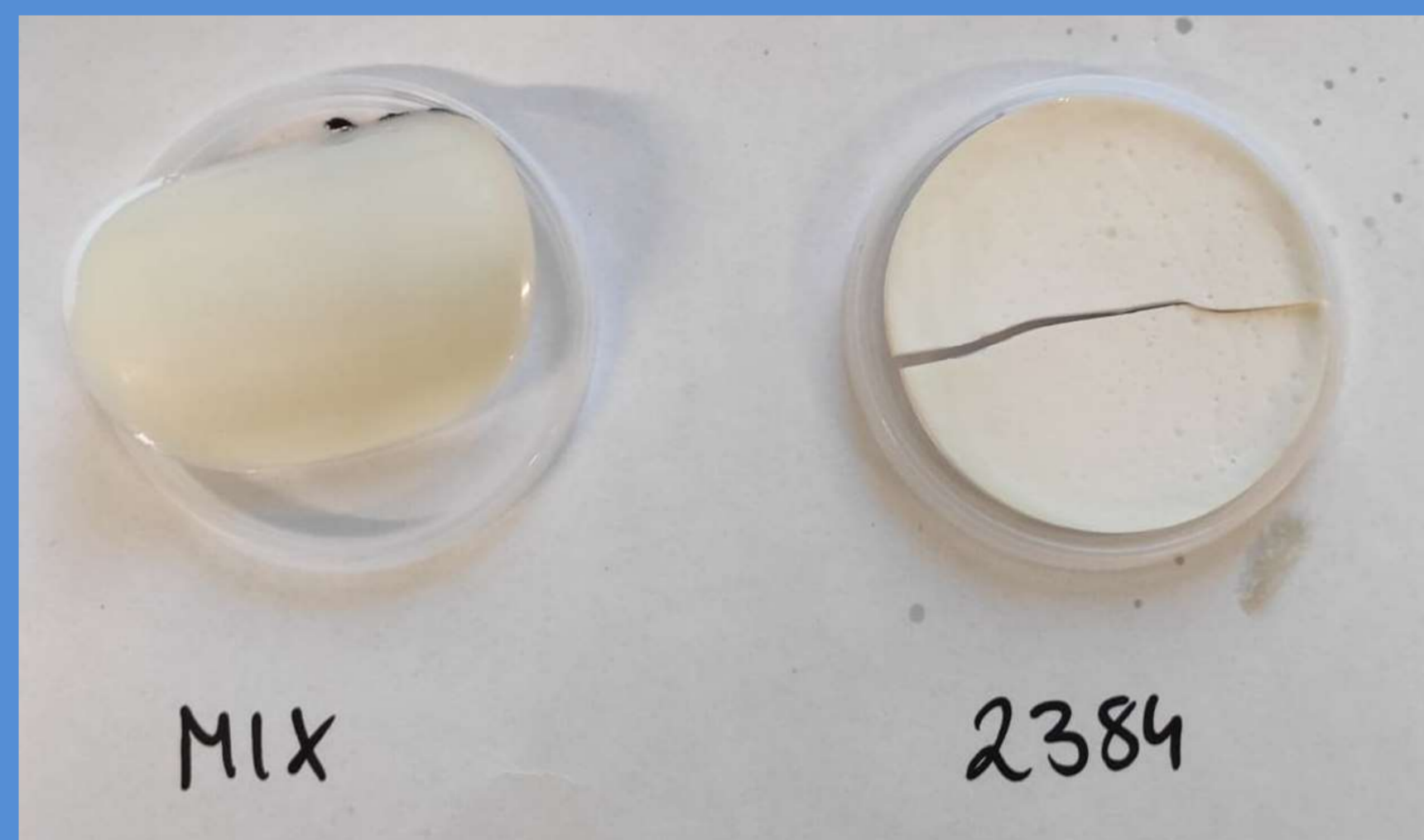
Różnica pomiędzy powłoką na bazie wodorozcieńczalnej żywicy epoksydowej (po prawej) a mieszaniny żywicy (po lewej)
